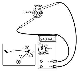
Figure 24. 120/240V Receptacle (240V)
